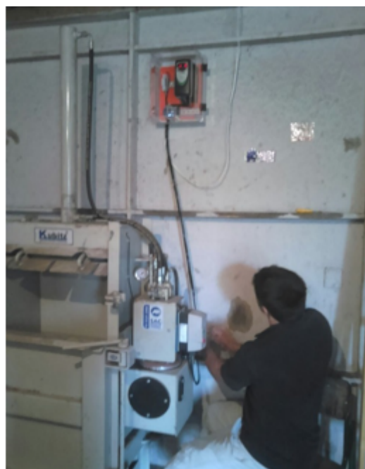
Figura 4 – Instalação do inversor de frequência para o perfeito funcionamento da prensa
