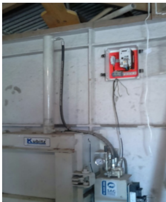
Figura 4 – Instalação do inversor de frequência para o perfeito funcionamento da prensa
